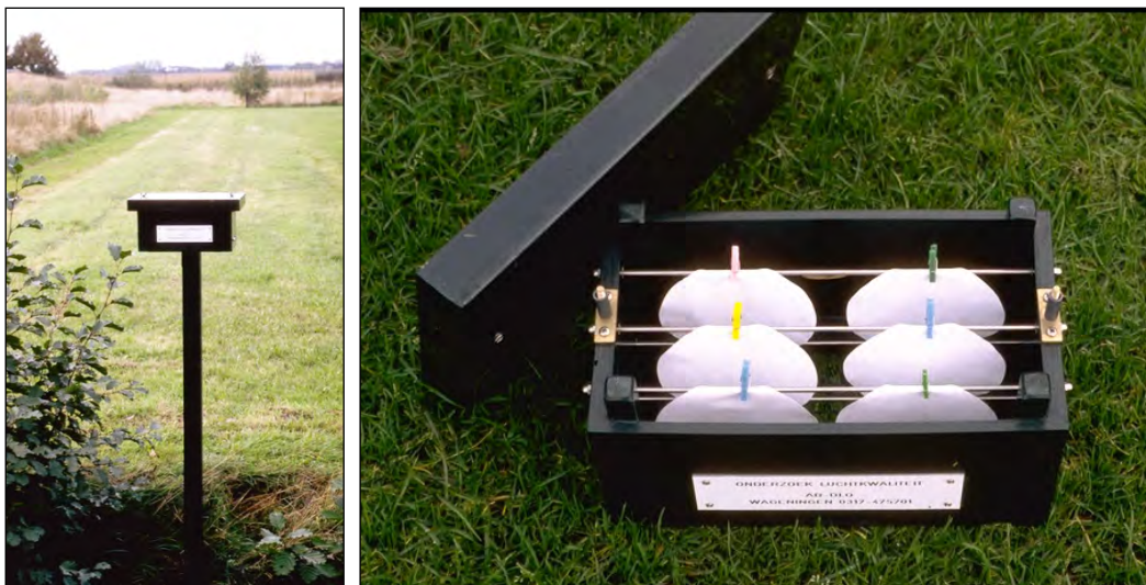
Figuur II-3. Links een 'fluoridenkastje' in het veld en rechts een bovenaanzicht van het kastje met de geïmpregneerde filtreerpapertjes.
