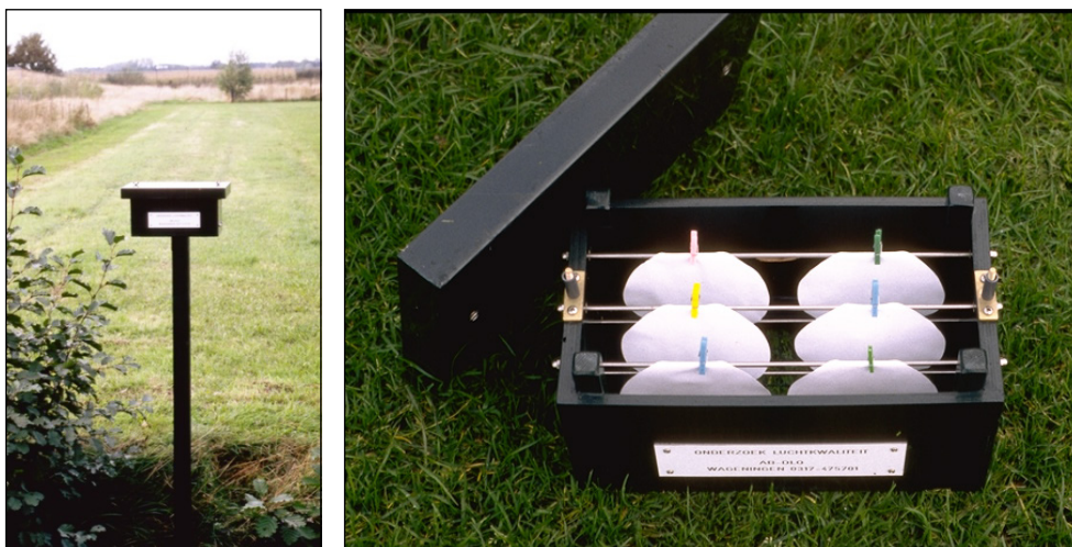
Figuur B2.3 Links een 'fluoridenkastje' in het veld en rechts een bovenaanzicht van het kastje met de geïmpregneerde filtreerpapertjes.
