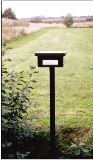
Figuur B2-3 Links een 'fluoridenkastje' in het veld en rechts een bovenaanzicht van het kastje met de geïmpregneerde filterpapierjes.
