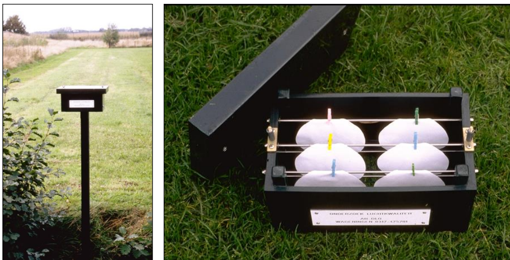
Figuur B2-3 Links een 'fluoridenkastje' in het veld en rechts een bovenaanzicht van het kastje met de geïmpregneerde filtreerpapiertjes.
