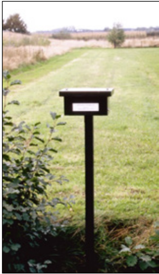
Figuur B2-3 Links een 'fluoridenkastje' in het veld en rechts een bovenaanzicht van het kastje met de geïmpregneerde filtreerpapierjes.
