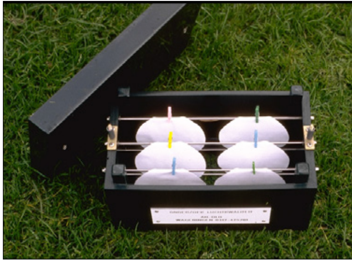
Figuur B2-3 Links een 'fluoridenkastje' in het veld en rechts een bovenaanzicht van het kastje met de geïmpregneerde filtreerpapierjes.
