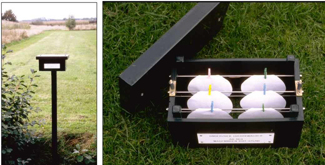
Figuur B2-3 Links een 'fluoridenkastje' in het veld en rechts een bovenaanzicht van het kastje met de geïmpregneerde filtreerpapierjes.
